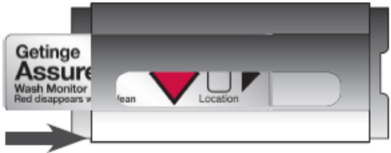
Švaros indikatoriaus testas įdedamas į laikiklį
